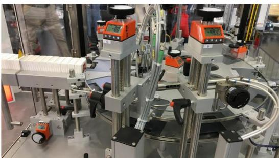
*Indicadores electrónicos de posición DD52R-E-RF de Elesa+Ganter en una máquina de envasado de JW Verpackungstechnik*
